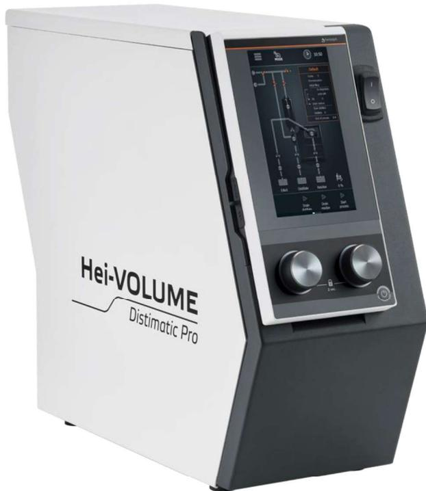
通过可移动的7英寸触摸屏控制面板，你可以在传感器模式或定时模式下输入参数对蒸发瓶进行蒸馏样品的补充，此外，还可以通过压缩机对覆膜集液器（约1L）进行冷凝液和残留物排空的时间进行编程。另外，可以启动自动清洗模式和手动模式。使用随附的支架，可将Hei-VOLUME Distimatic Pro 24/7自动蒸馏模块直接安装在Hei-VAP大型工业旋转蒸发仪上。
